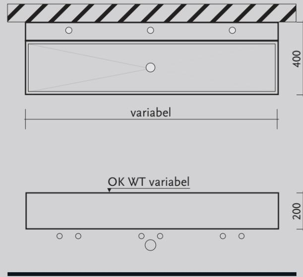
**Finoflex-Waschtischrinne, Modell FFWT4oRR,** rechteckig, aus Massiv-Mineralwerkstoff, 12 mm stark, schwerentflammbar (B1), desinfektionsmittelbeständig, antibakteriell (weiß), (bei Montage an Trockenbauwänden sind Verstärkungen anzubringen), mit fugenlos integrierter Rinne als Waschfläche, ohne Überlauf, mit drei Lochbohrungen für Einlochbatterie Ø 35 mm, einer Ablaufbohrung und erforderlichem Montagezubehör (verzinkte Konsolen),
